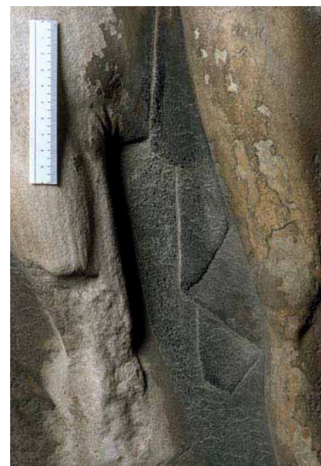
Εικ. 5. Δυτική Ζωφόρος λίθος V. Κρούστα με ανακρυσταλλώσεις (φωτ. Σ. Μαυρομάτης, Αρχείο Υ.Σ.Μ.Α.).
