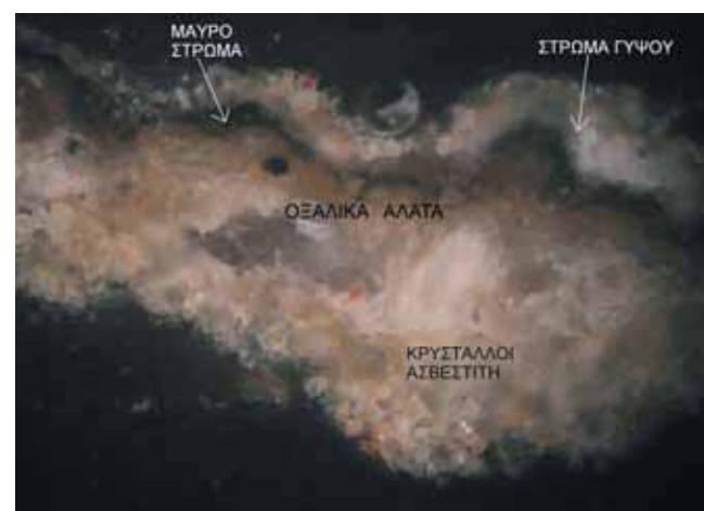
Εικ. 23. Εικόνα δείγματος στο πολωτικό μικροσκόπιο, όπου σημειώνεται η στρωματογραφία του.
