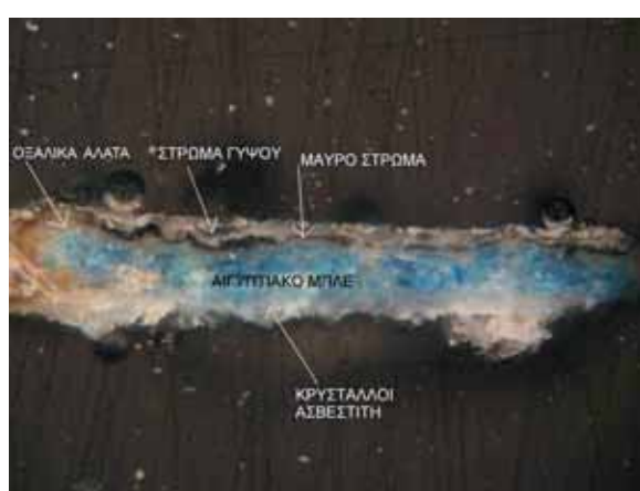
Εικ. 24. Εικόνα δείγματος στο πολωτικό μικροσκόπιο, όπου σημειώνεται η στρωματογραφία του.
