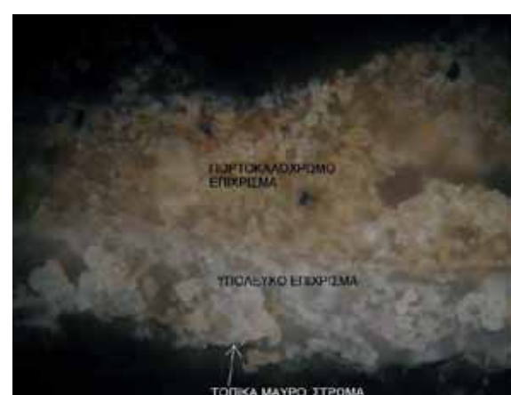
Εικ. 25. Εικόνα δείγματος στο πολωτικό μικροσκόπιο, όπου σημειώνεται η στρωματογραφία του.
