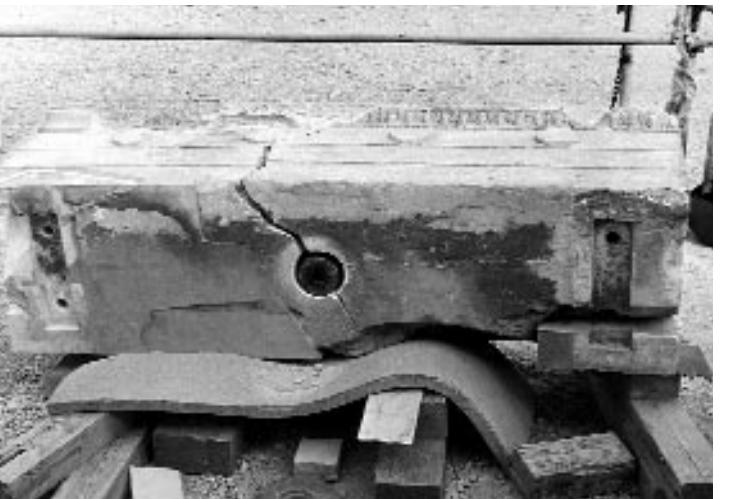
Θραύση εποπτιλίου της N πρόστασης του Ερεχθέου, λόγω του αιδάρου και του ταμένου που χρησιμοποιήθηκαν στην επέμβαση του N. Μπαλάνου. Φωτ. Α. Τζάκου,
