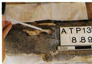
Σχ. 42. Εμποτισμός αποσαθρωμένου μαρμάρου για αποκατάσταση της συνοχής των κρυστάλλων.
