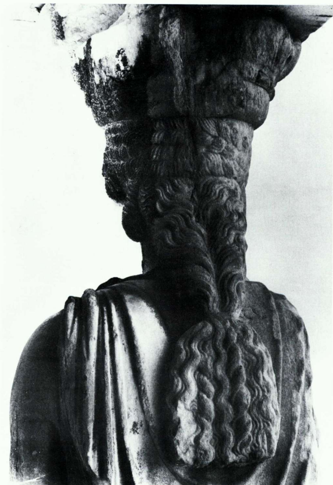
Σχ. 4β. Γυψοποίηση στην πίσω όψη Καρνάτιδος. Επιφάνεια προστατευμένη από το νερό της βροχής.
