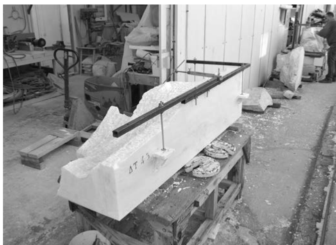
Παραδοσιακή μέθοδος διαμόρφωσης συμπληρώματος λιθοπηλίνθων με πονταδόρο. Φωτ. Κ. Σκαρής, 2020
