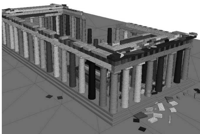
Αποτελέσματα της αριθμητικής ανάλυσης για την περίπτωση των ελεύθερα ιστάμενων ορθοστατών. Αριστερά: Σεισμός Bagnoli-Irpinio - Ανατροπή του κεντρικού τμήματος του τυμπάνου. Δεξιά: Σεισμός Αθήνας - Ανατροπή του κεντρικού τμήματος του τυμπάνου.
