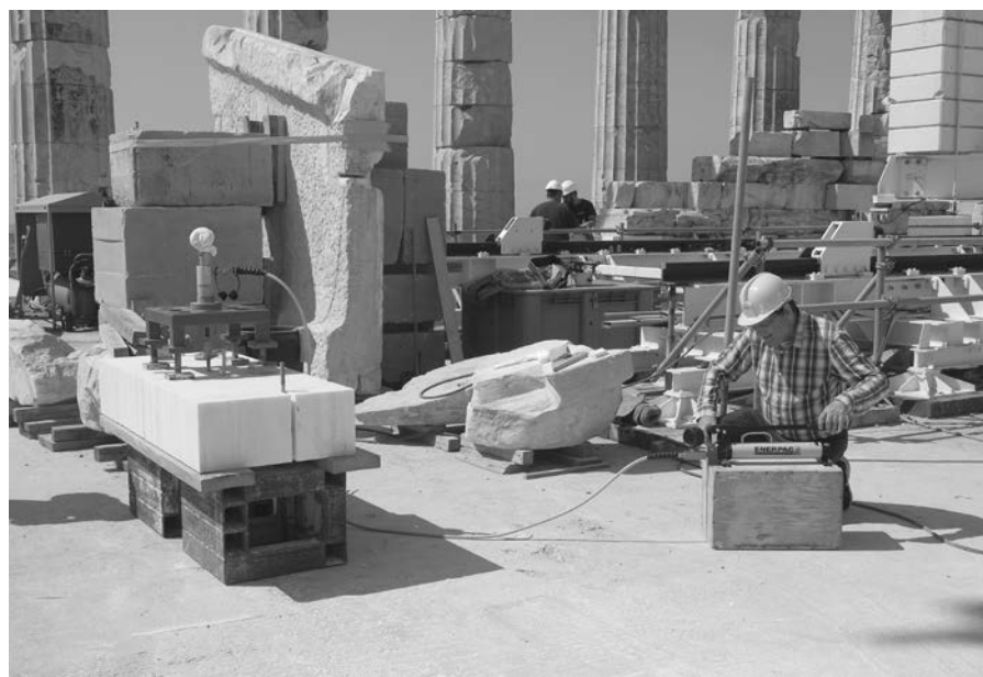
Στιγμιότυπα από τις δοκιμές. Δεξιά, αποτυπώνεται η στιγμή αστοχίας του συστήματος αγκύρωσης.
