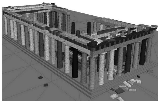
Αποτελέσματα της αριθμητικής ανάλυσης για την περίπτωση των ελεύθερα ιστάμενων ορθοστατών. Αριστερά: Σεισμός Bagnoli-Irpinio - Ανατροπή του κεντρικού τμήματος του τυμπάνου. Δεξιά: Σεισμός Αθήνας - Ανατροπή του κεντρικού τμήματος του τυμπάνου.
