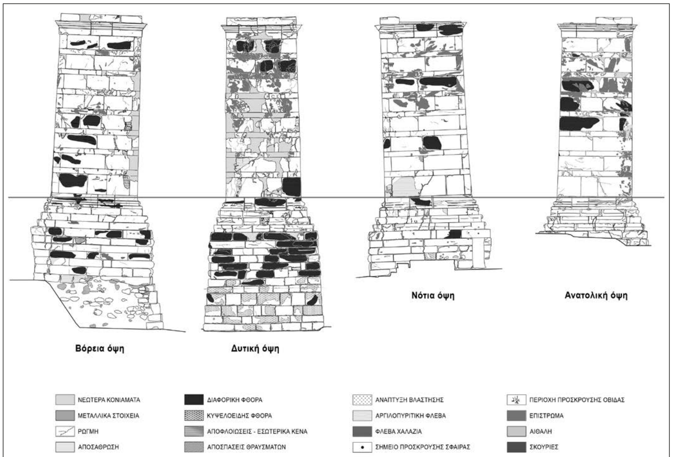
Παθολογία της επιφάνειας του μνημείου. Χαρτογράφηση της κατάστασης διατήρησης της επιφάνειας: Κ. Φραντζικινάκη, 2022
