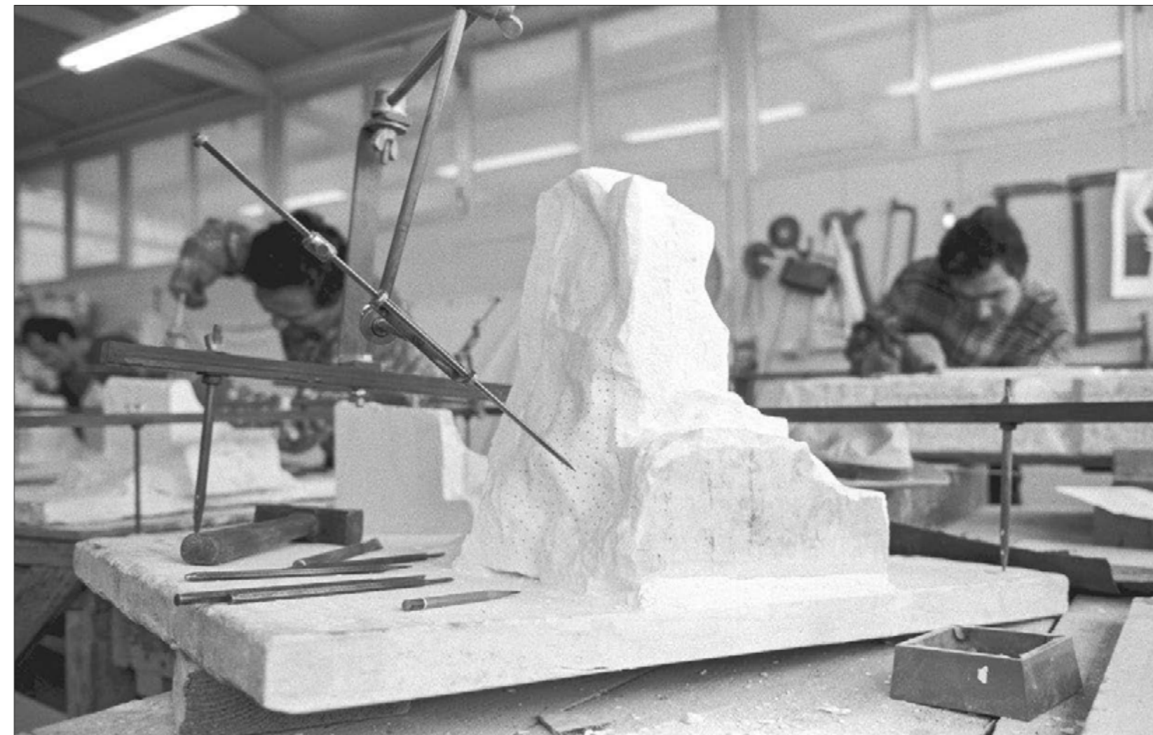
Προπύλαια. Αντιγραφή εκμαγείου με χρήση πονταδόρου για τη διαμόρφωση συμπληρώματος φατνωματικής πλάκας της δυτικής αίθουσας (1997)
